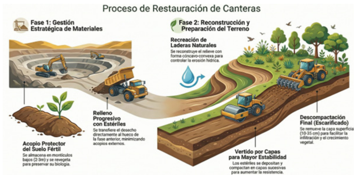
Figura 18. Restauración de canteras integrando la minería de transferencia y metodología de la SER, 2004. Figure 18. Quarry restoration integrating transfer mining and SER methodology, 2004.
