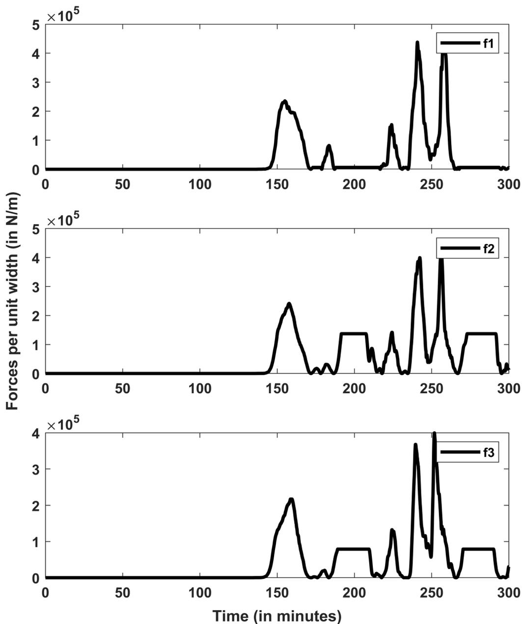
**Figure 11.** Tsunami Force per unit width with respect to time computed at three different locations along the beach road where the boulders acted as a sea wall. / **Figura 11.** Fuerza del tsunami por unidad de ancho con respecto al tiempo calculado en tres lugares diferentes a lo largo del camino de la playa donde los cantos rodados actuaban como un malecón.
