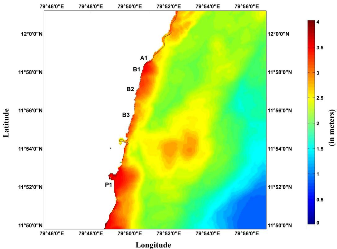
Figure 10. Run-ups along the coast of Pondicherry with the maximum run-up of about 4m near Paradise Beach. / *Figura 10. Carreras a lo largo de la costa de Pondicherry con una carrera máxima de unos 4 m cerca de Paradise Beach.*
