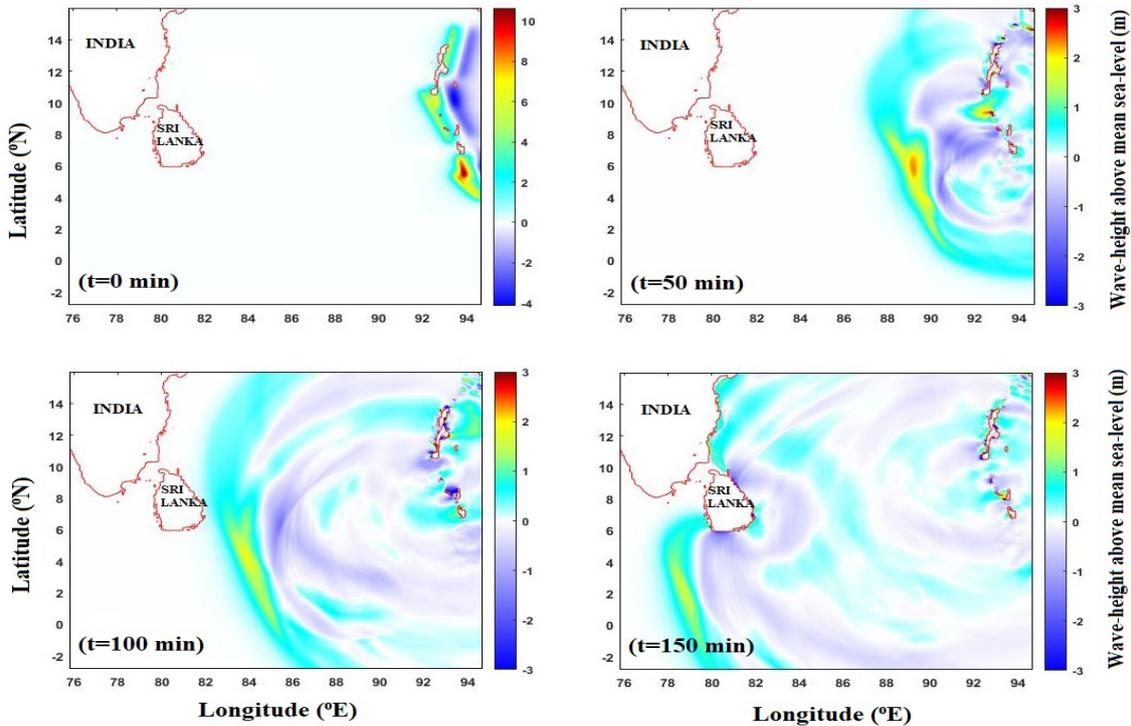
Figure 8. Tsunami wave propagation along the Indian Ocean. / **Figura 8.** Propagación de ondas de tsunami a lo largo del Océano Índico.
