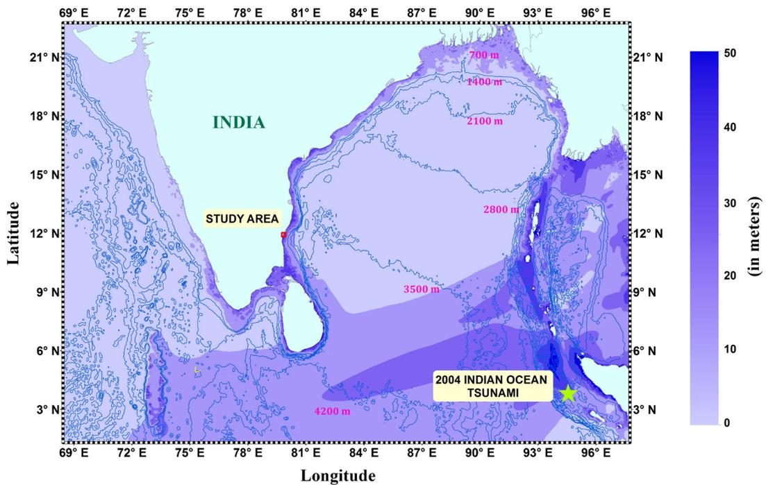
Figure 9. Tsunami directivity map for the 2004 Sumatra tsunami showing the maximum wave heights. / *Figura 9. Mapa de directividad del tsunami para el tsunami de Sumatra de 2004 que muestra las alturas máximas de las olas.*
