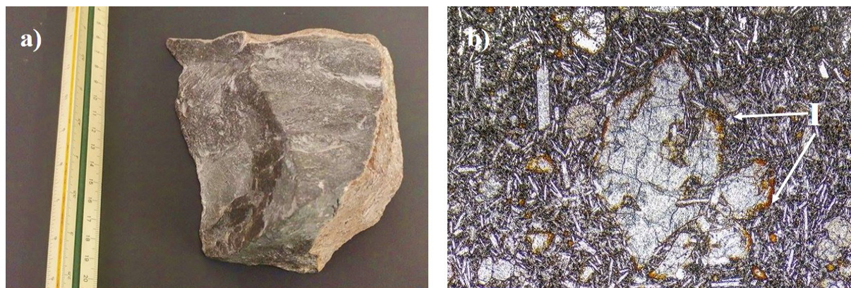
Figura 5. A) Muestra de mano de basalto en donde se puede apreciar tanto la parte fresca como la zona alterada, principalmente por oxidación. B) Fotografía de microscopio con luz natural y aumento de 5x en donde se observan los cristales de olivino con el borde de iddingsita. / Figure 5. A) Hand sample of basalt where it is possible to appreciate the fresh and the altered rock by oxidation. B) Microscope photograph with natural light and 5x of zoom where olivine crystals have an iddingsite edge.
