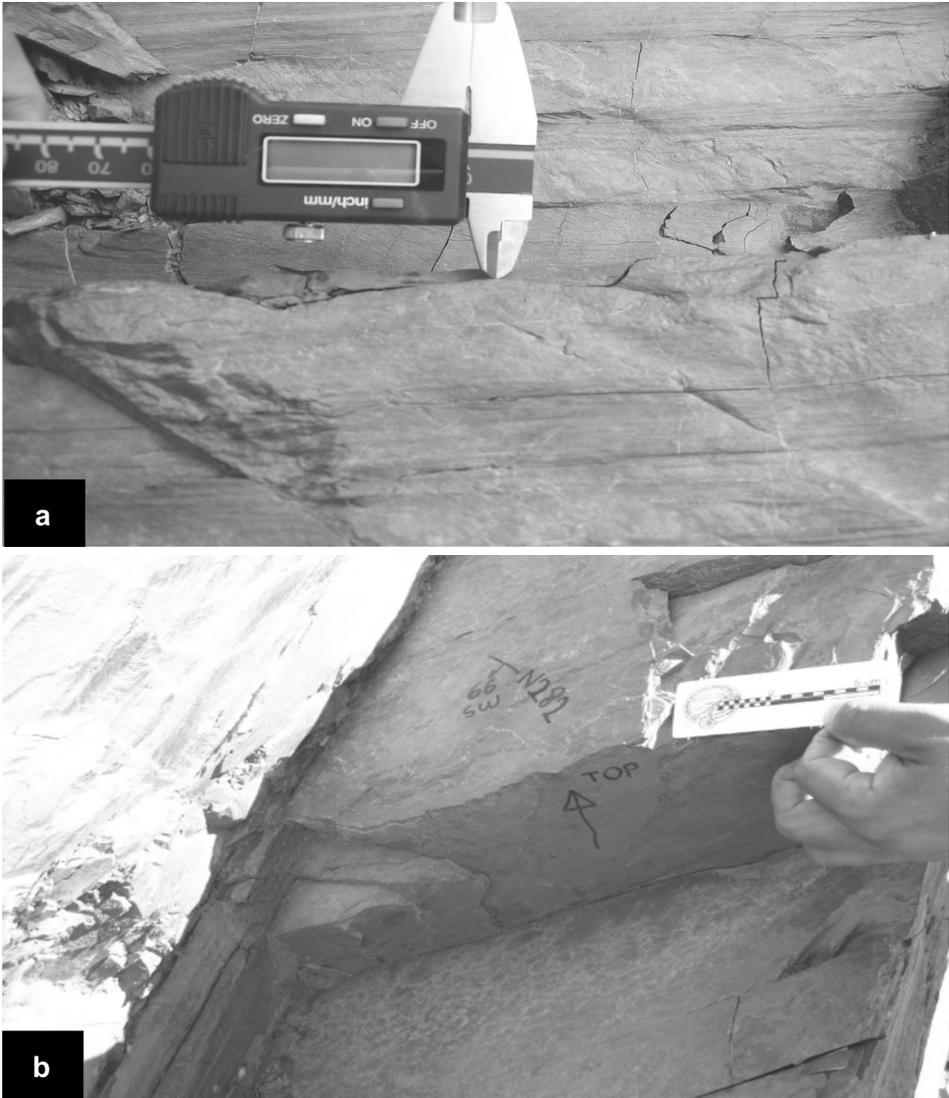
Figura 4. a) Medición efectuada con calibre digital. b) Toma de muestra orientada.
