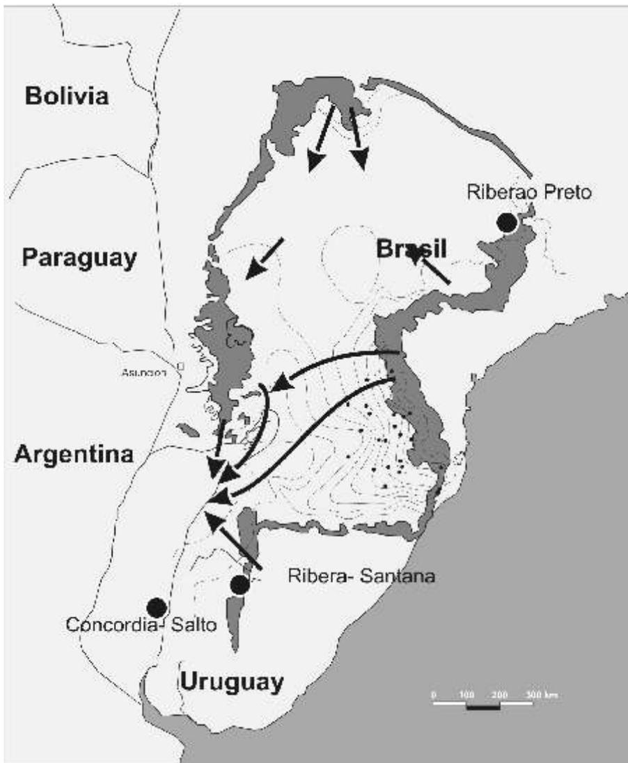
Figura 67 : Acuífero Guaraní: la trama oscura oscura corresponde a los afloramientos que determinan el borde de la cuenca del acuífero. Isopiezas están representadas por las líneas curvas y las flechas el sentido de circulación del SAG .Modelo elaborado por la Comisión del SAG
