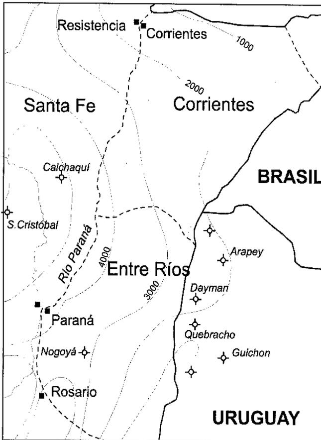
Figura31: Espesores totales sedimentarios con indicación de isopacas (igual espesor), según Pezzi et al, (1989)
