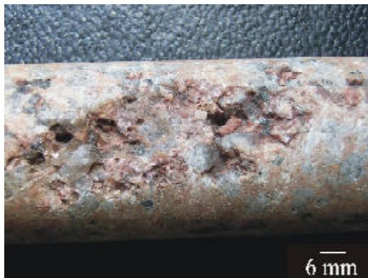
Fig. 44: Estructura miarolítica en un testigo de perforación de granito.
