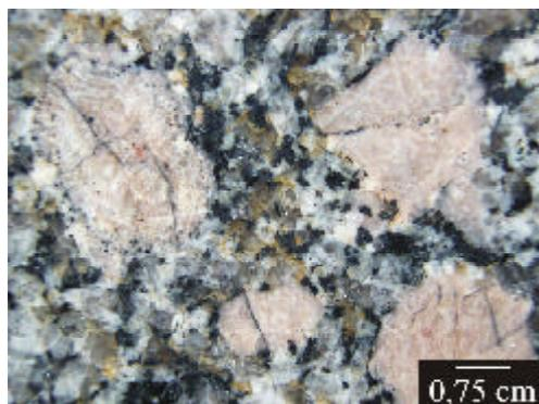
Fig. 8: muestra de mano pulida de un granito porfirico con megacrystalos de Feldespato Potásico.
