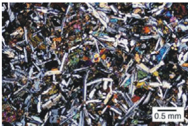
Fig.39: muestra de dolerita con textura intergranular. Cpx (minerales coloreados) y Ol incluidos en individuos de plagioclasa ( Nx, x15).
